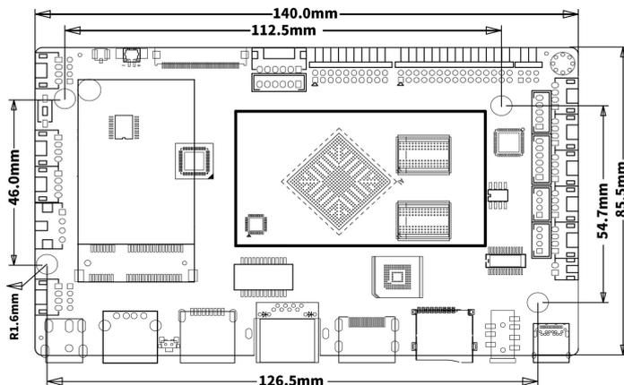
\*PCBA 长度: 140mm \*PCBA 宽度: 85.5mm \*PCBA 高度: 12mm \*PCBA 螺丝孔径: 3.2mm x4
