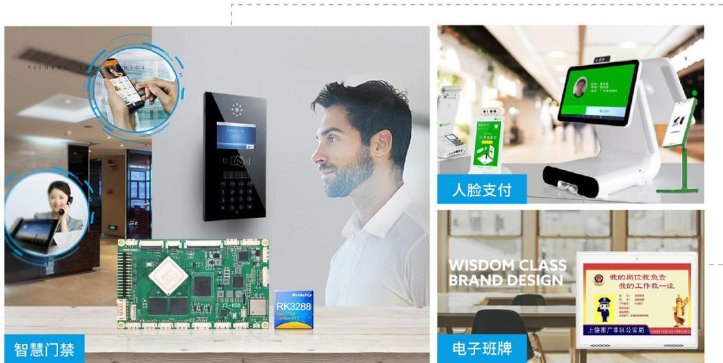
YS-H88 属于智能安卓主板，具有丰富的控制接口和外拓接口，完美支持信息发布系统，支持远程制作、发布、管理和实时更新节目，支持本地/网络定时开关机；该产品尺寸小，轻薄等优势；是一款高效、安全、高可靠性的产品。
