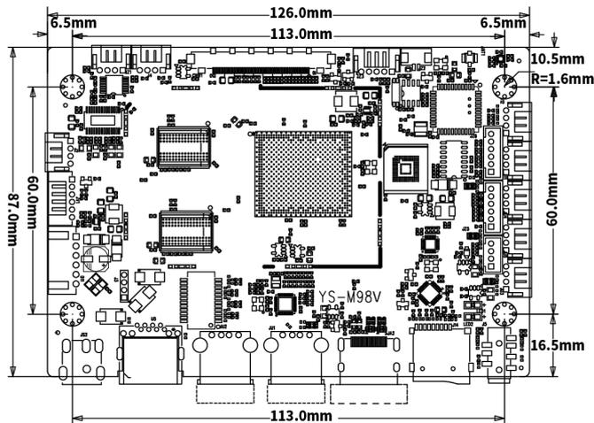
\*PCBA 长度: 126mm \*PCBA 宽度: 87mm \*PCBA 高度: 12mm \*PCBA 螺丝孔直径: 3.2mm x4
